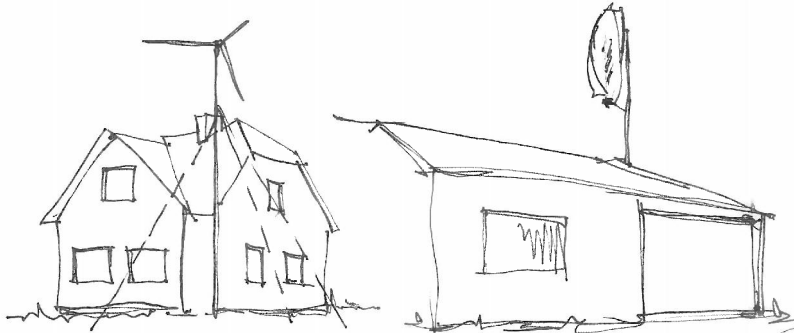
Oikealla vaaka-akselinen potkurityyppinen voimala ja vasemmalla pystyakselinen voimala
